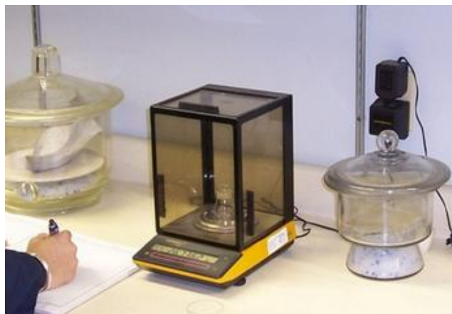
Figura 707 - 2. Determinación de la masa de picnómetro vacío con el tapón
